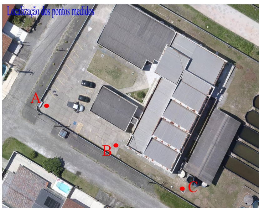
Figura 01 – Localização dos pontos utilizados na determinação de cotas e diferenças de nível para os métodos visadas iguais, visadas recíprocas e visadas equidistantes e visadas extremas.
